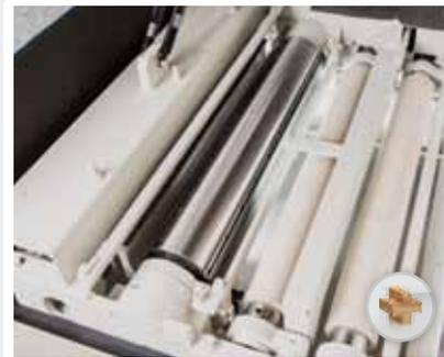
*Beeindruckend: das Innenleben. Druckbalken und Walzen sind pendelnd gelagert. Zwei Auszugswalzen sorgen für starken Durchzug. Gliederdruckbalken in Gußausführung.*
