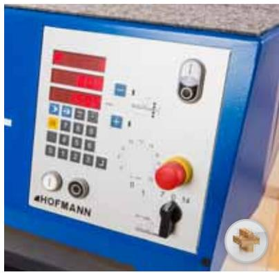
*Bedienpult mit Positioniersteuerung (Option) mit 250 Speicherplätzen, sowie Kettenmaßpositionierung. Vorschub 7 + 14 m/min.*
