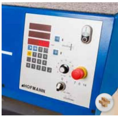
*Modernes Bedienpaneel ergonomisch günstig. Hier mit stufenlosem Vorschub (Option) Betriebsstundenzähler inklusive.*
