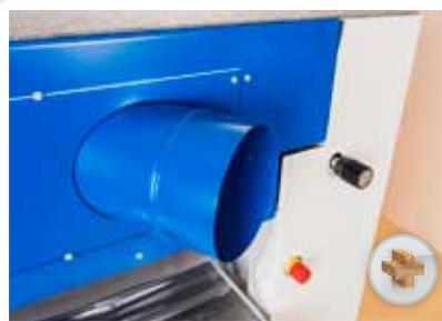
*Praktisches Detail: der von außen einstellbare Auszugsdruckbalken.*
